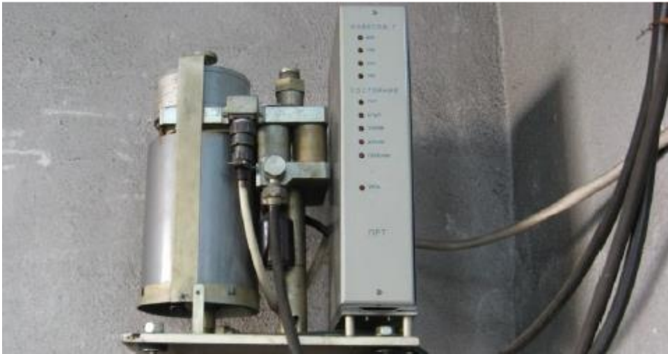
Рис. 2.7. Датчик ГСП БА - 1005 для визначення витрати дизельного палива.
