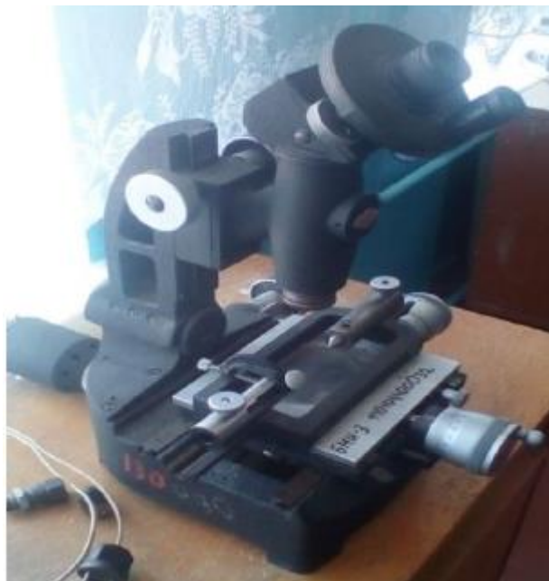
Рис. 2.4. Мікроскоп БМИ-3 для дослідження вагового зносу голки і корпусу розпилювача
