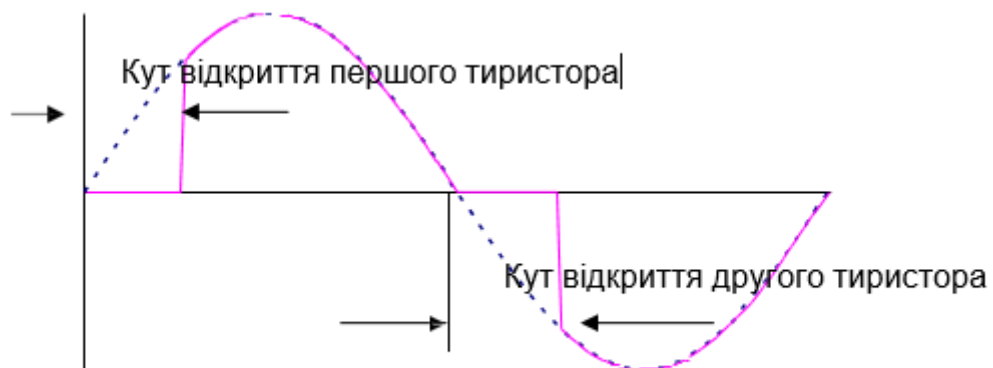
Рисунок 1.7 - Зустрічно-паралельно увімкнені тиристири
