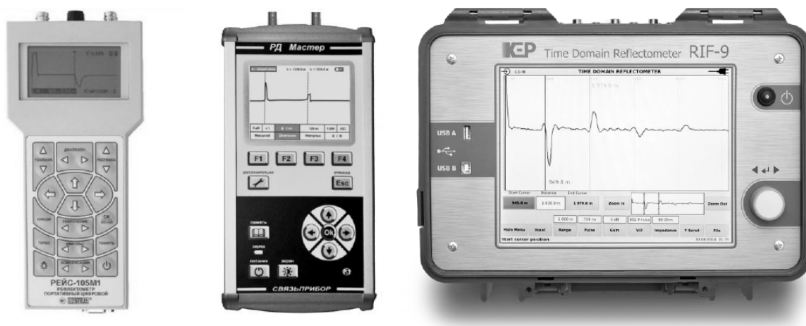
Рисунок 1.4 - Сучасні прилади імпульсної рефлектометрії
