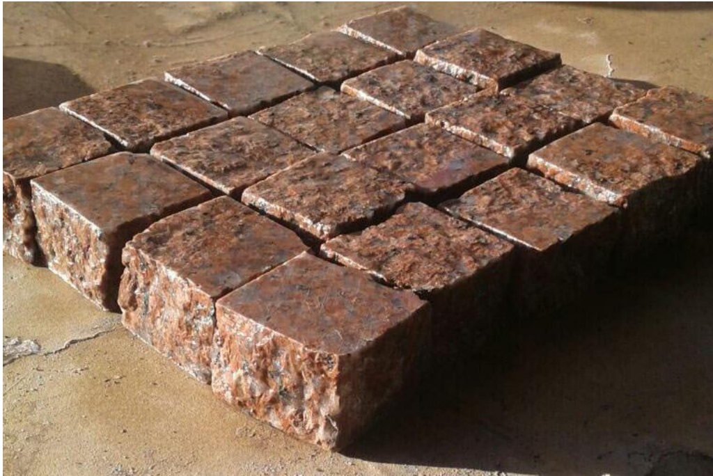
Рис 3.2. Бруківка пиляно-колота з колотими краями з червоного граніту Rosa Raveno[17]
