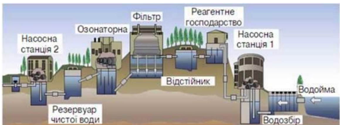
Рисунок 2.1 Технологічна схема очистки води на ВОС [16, с. 29]
