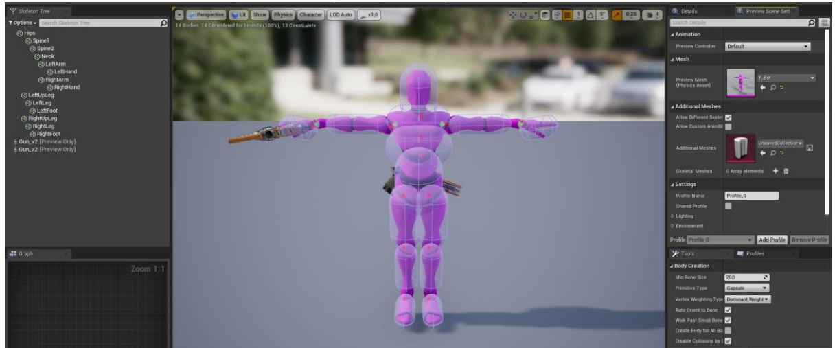
Рис. 2.10 – Physics Asset, що прив'язується до скелету моделі
