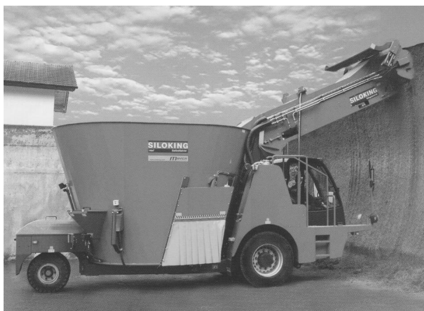
Рис. 2.5. Самохідний змішувач-кормороздавач фірми Siloking.
