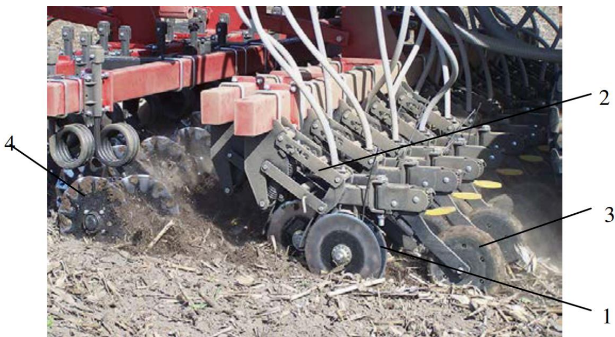
Рис. 1.1. Сошник сівалки Salford 520: 1 – сошник; 2 – паралелограмний важільний механізм; 3 – каток; 4 – дисківий ніж.
