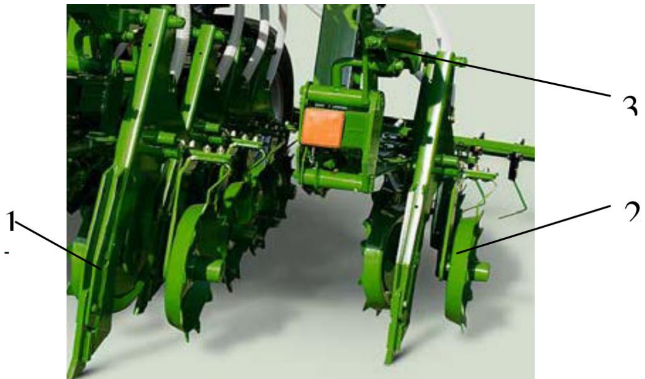
Рис. 2.2. Сошник сівалки Amazone Primera DMC: 1 – долотоподібний сошник; 2 – каток, 3 – паралелограмний механізм.
