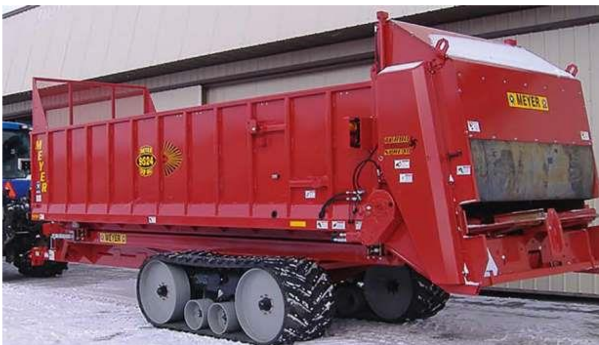
Рис. 1.2.3. Розкидач органічних добрив із гусеничними рушіями моделі Meyer 9524[12]
