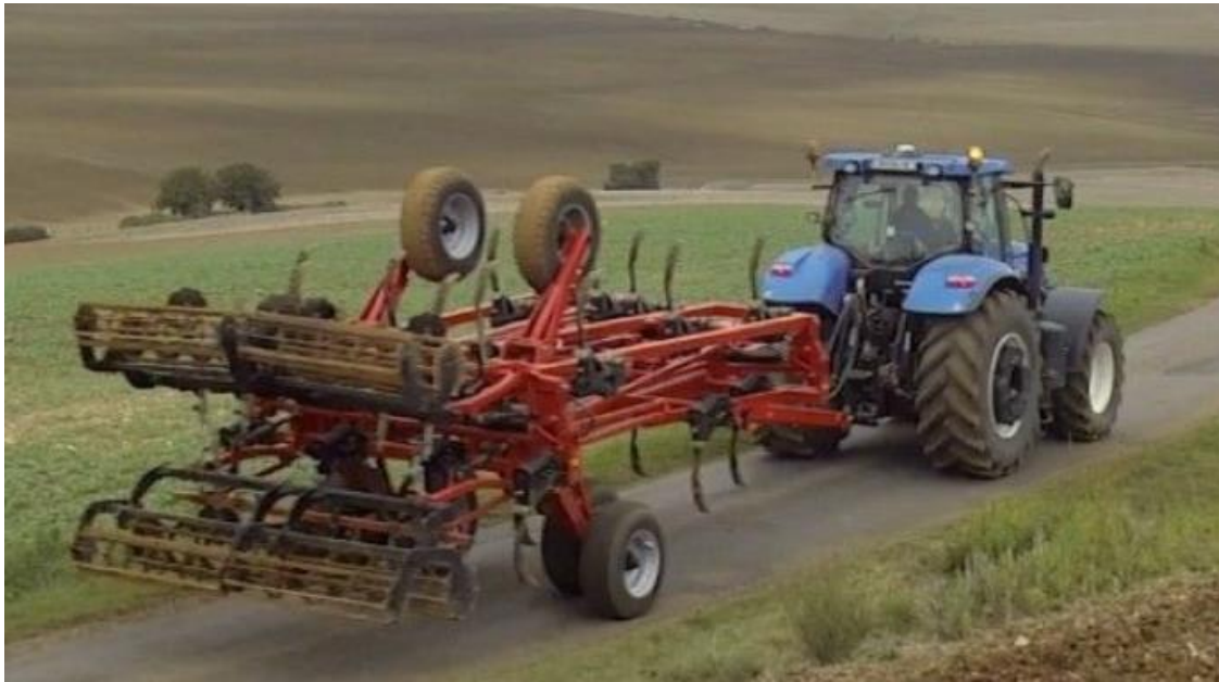
Рис. 1.9. Культиватор Crossland T 70 [2]
