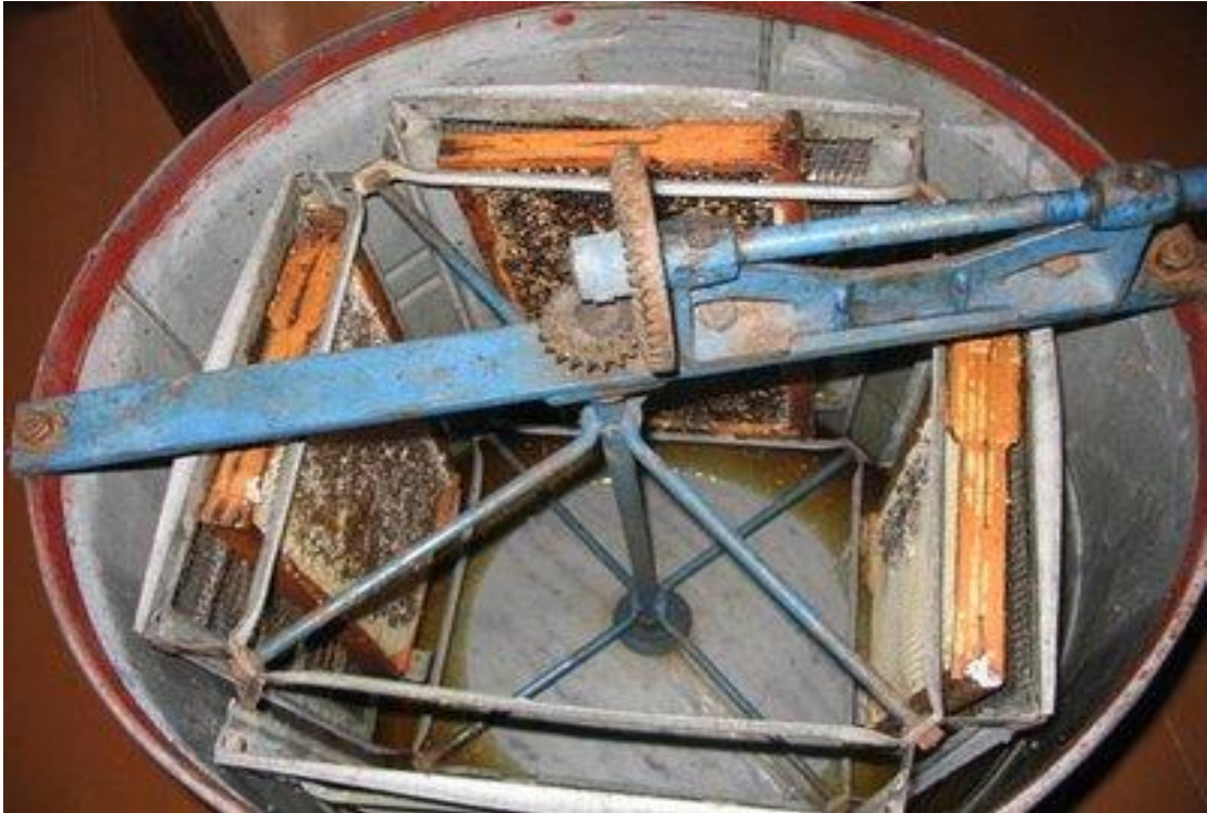
Рис. 3.1. Відкачування меду на 4-рамковій хордіальній медогонці
