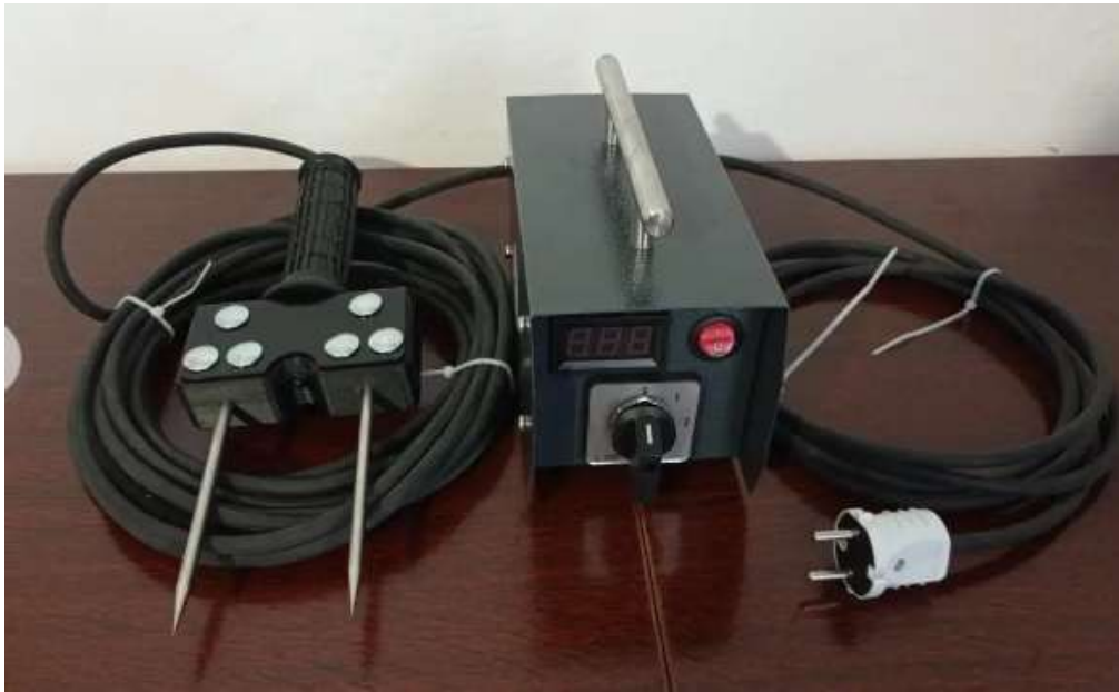
Рис. 11. Пристрій для електрооглушення сільськогосподарських тварин
