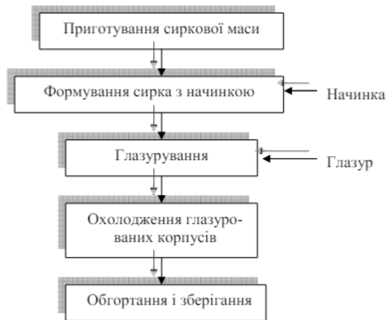
Рис. 3.16. Технологічна схема виробництва глазурованих сирків з начинкою, що базується на параметрах
