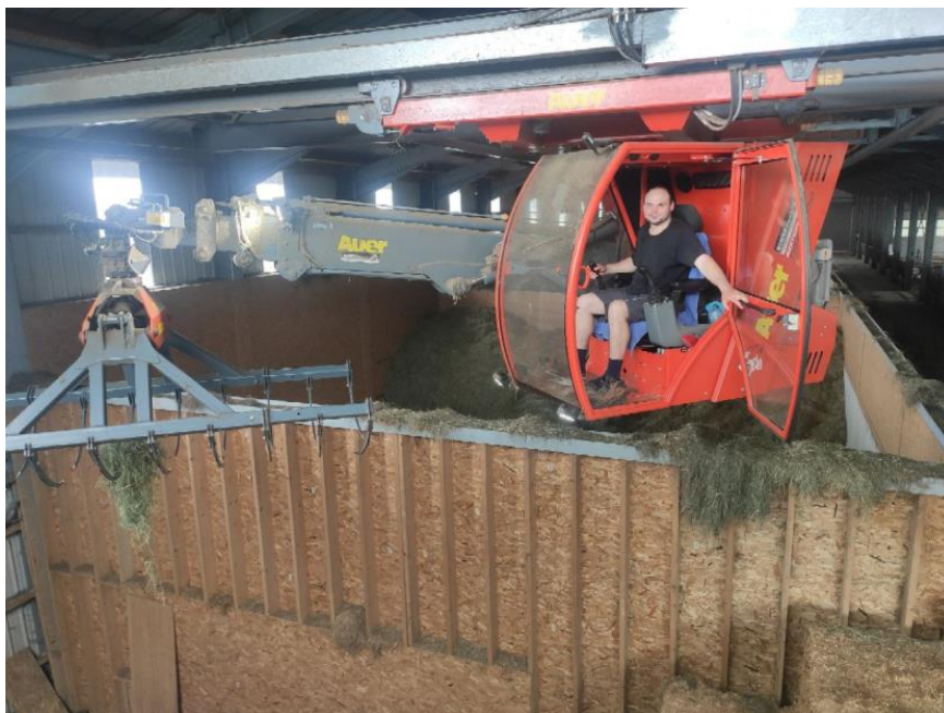
Рис. 9. Агрегат електрогідравлічний для закладки/забирання сіна в/з сушильних боксів
