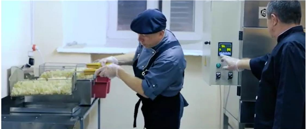
Рис. 3.8. Програмування температури обсмажування снеків.
