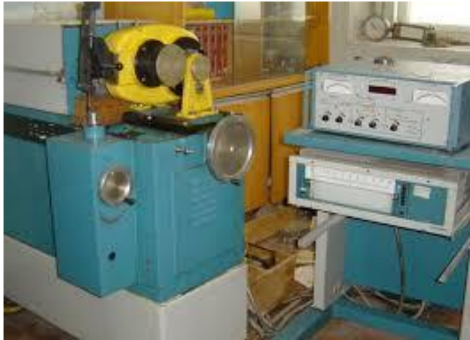
Рис. 2.9. Спеціальна машина для проведення дослідження тертя та зношування С М Ц - 2
