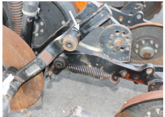
Рис. 1.10. Точки змащування трибоспряження з підшипником ковзання (стрілка вказує на точку обслуговування рухомого з'єднання висівної секції) [8]
