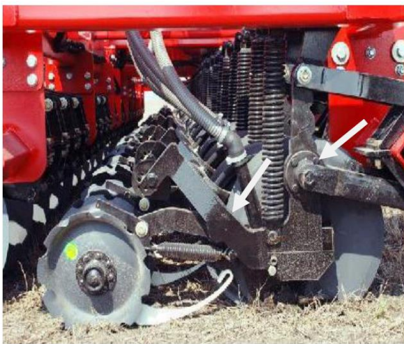
Рис. 1.10. Точки змащування трибоспряження з підшипником ковзання (стрілка вказує на точку обслуговування рухомого з'єднання висівної секції) [8]
