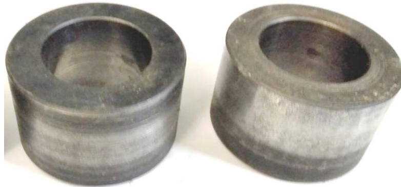
Рис.2.10. Спеціальне кільце для виміру зносу деталей з композитних матеріалів
