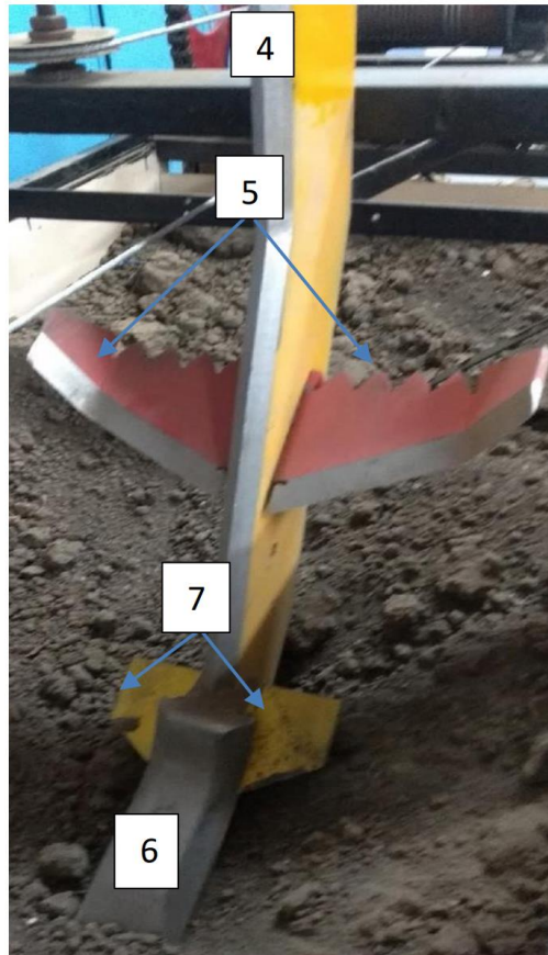
Рис. 3.18. Робочий орган глибокорозпушувача з повним комплектом ґрунторозпушувальних елементів
