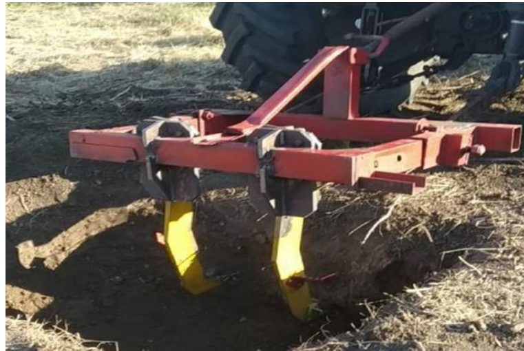
Рис. 3.20. Налаштування кутів установлення стійок глибокорозпушувача.
