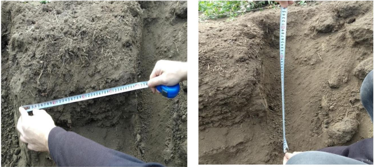
Рис. 3.22. Параметри внутрішньогрунтової стінки
