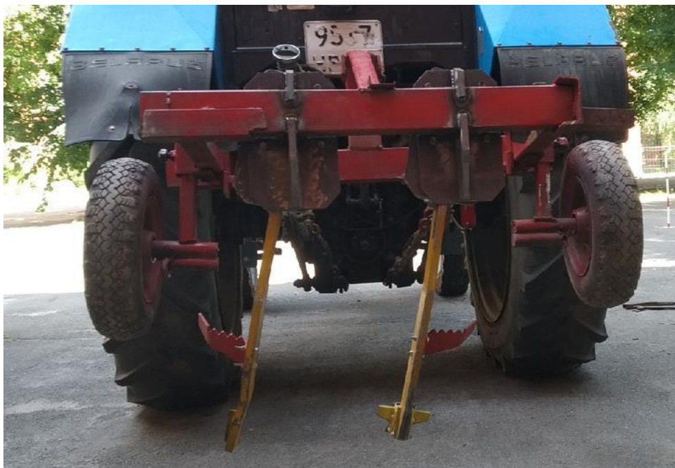
Рис. 3.19. Зміна кута стійок експериментального глибокорозпушувача.
