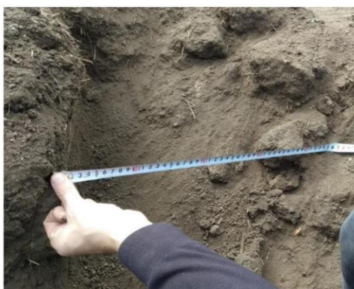
Рис. 3.23. Зона розпушення стійки глибокорозпушувача з розширювачем.
