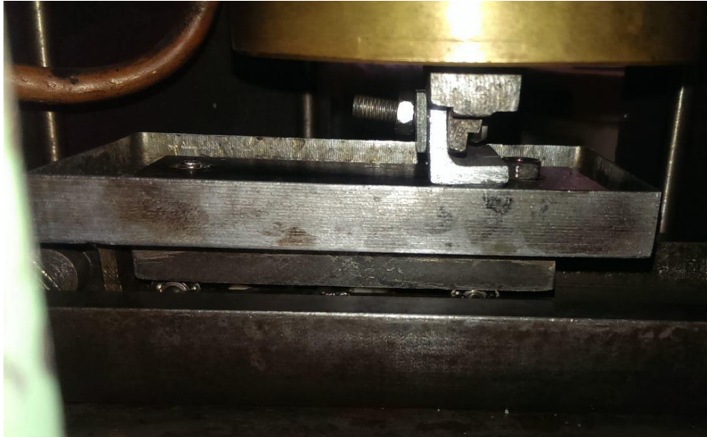
Рис. 2.8. Встановлений у тримач зразок для випробування на зносостійкість
