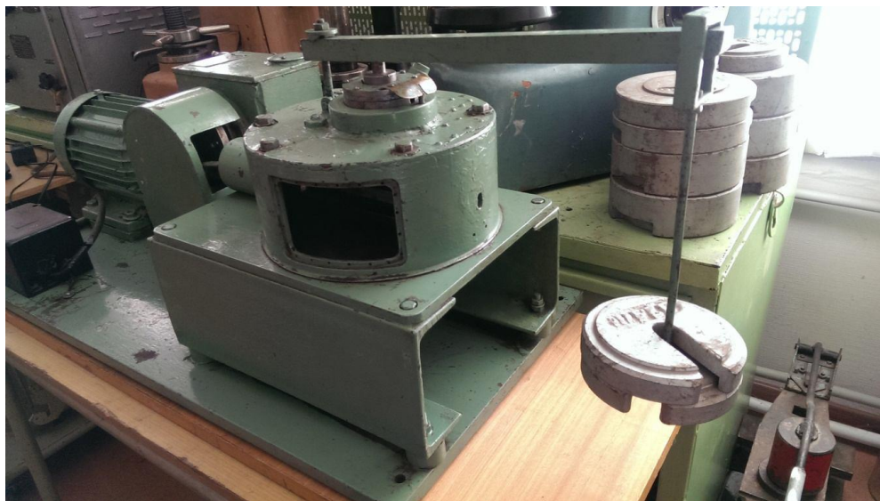
Рис. 2.4. Машина тертя 77 МТ-1.
