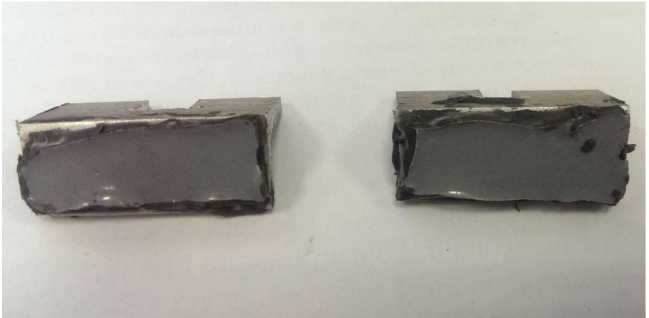
Рис. 2.1. Зразок (куточок) із нанесеним матеріалом для випробувань на зносостійкість.
