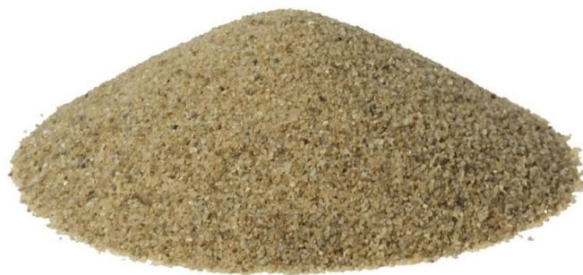
Рис. 2.17. Кварцовий пісок для моделювання абразиву.
