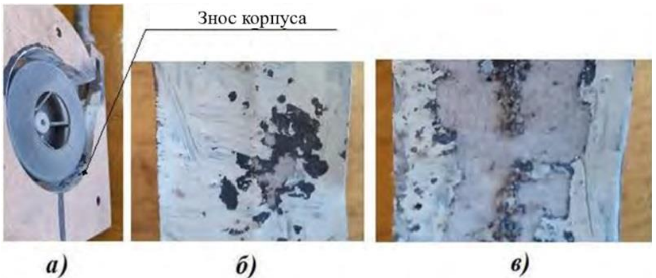
Рис. 3.12. Знос внутрішньої робочої поверхні корпусу моделі дробарки серії ДКР: а) – модель барабана дробарки; б) – нерівномірний знос до модернізації; в) – рівномірний знос після модернізації
