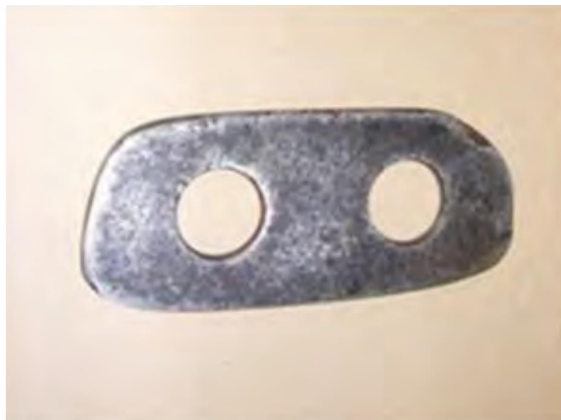
Рис. 1.6 Зношений молоток дробарки.
