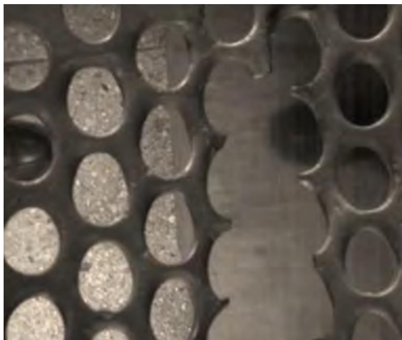
Рис. 1.7 Характер руйнування сепаруючого решета.
