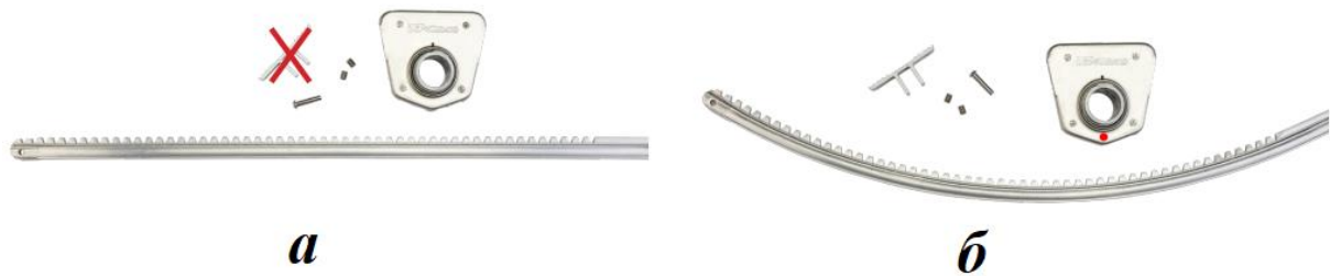
Рис. 4.3. Конструктивні особливості зубчастих рейок приводу вентиляційних фрамуг
