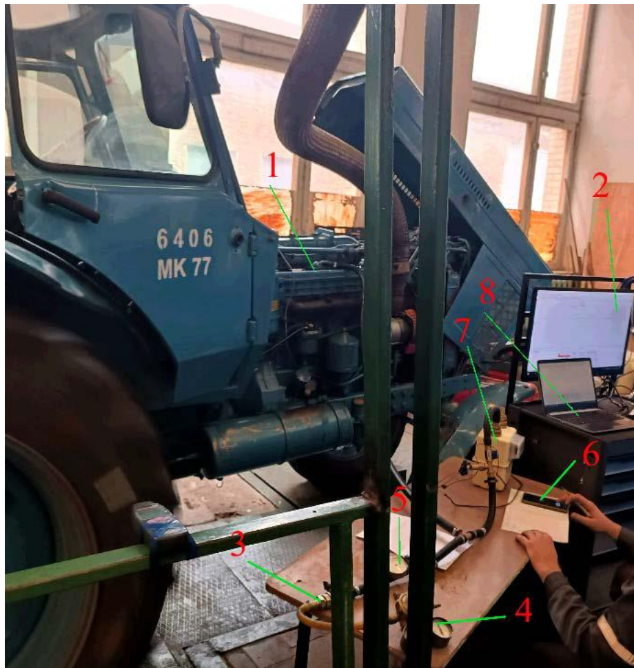
Рис. 2.8. Експериментальні дослідження під час вимірювання об'єму картерного простору двигуна у складі трактора МТЗ-80: 1 – двигун Д-240; 2 – екран осцилографа (мотортестр); 3 – регулювальний кран подачі повітря; 4 –
