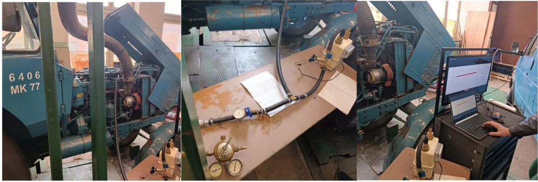
Рис. 2.4. Монтаж вимірювальної системи на двигун Д-240 у складі трактора МТЗ-80.
