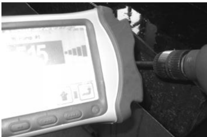
Рисунок 3.3. Безконтактний тахометр DeLaval VPR100.
