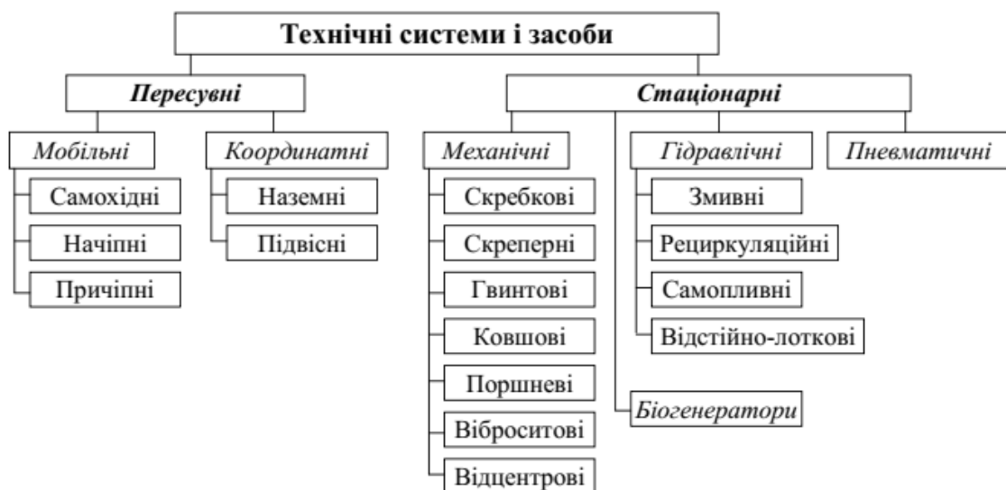
Рис. 1.1. Класифікація технічних системи і засобів механізації для видалення гною
