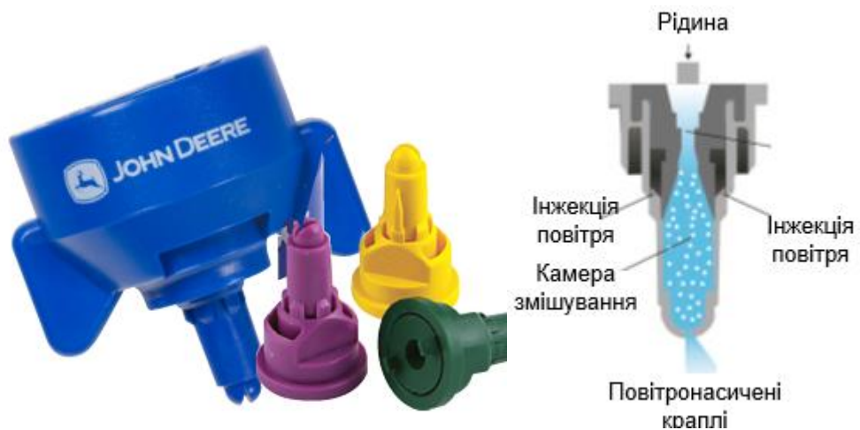
Рис. 3.9. Плоскофакельні форсунки з малим зносом Low-drift Air
