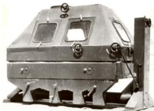
Рис.1.8. Пневматичний сортувальний стіл СПС - 5: а) конструктивна схема; б) загальний вид [10]
