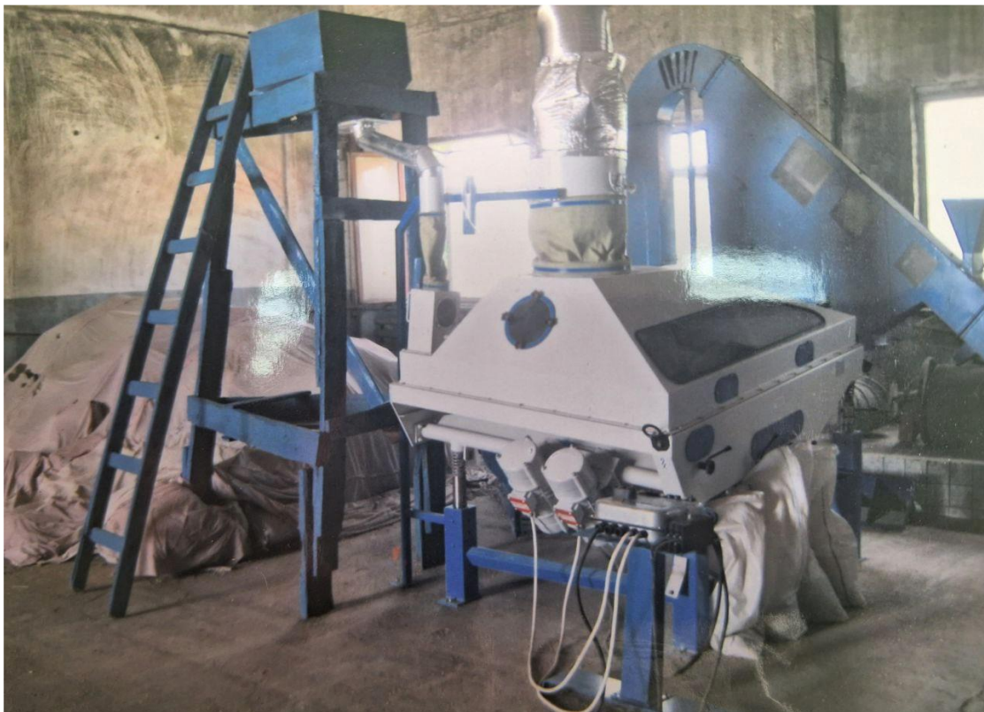
Рис.3.1. Підключення ПСС для проведення експериментальних випробувань
