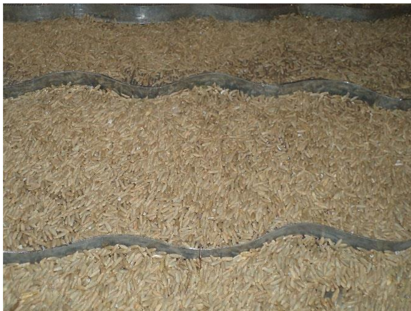
Рис.2.5. Загальний вигляд інтенсифікатора хвилеподібного типу при розділенні насіннєвого матеріалу
