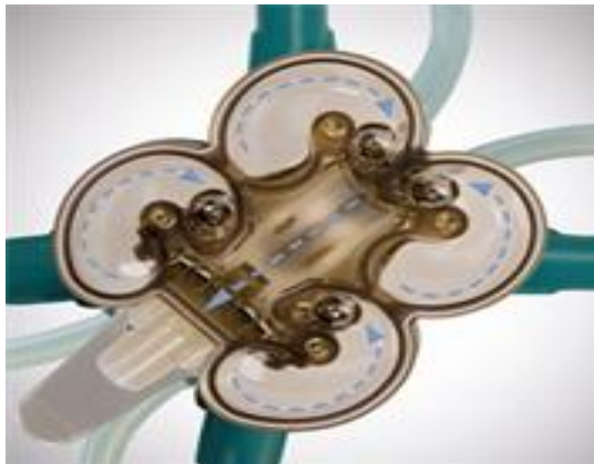
Рис. 1.4. Колектор доїльного апарата окремих долей вимені
