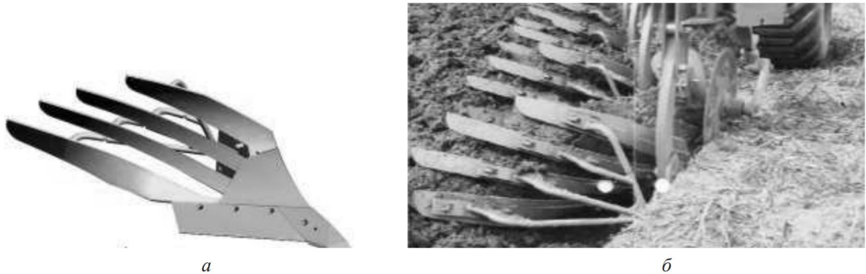
Рис. 1.3. Корпус Dura Maxx Hybrid: а – загальний вигляд; б – процес роботи
