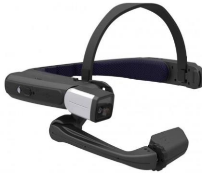
Рис. 2.1. Смарт-окуляри RealWear HMT-1
