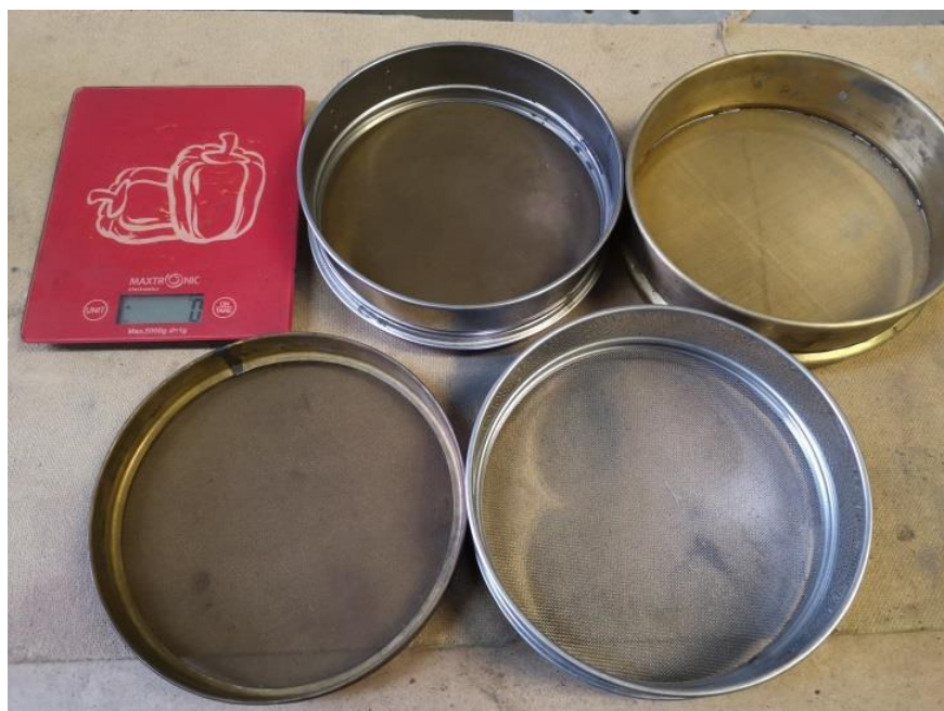
Рис. 3.2. Ваги та набір сит для визначення фракційного складу
