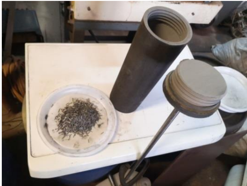
Рис. 3.1. Лабораторний стакан і феромагнітні елементи.
