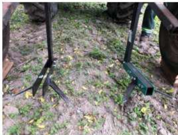
Рис. 1.12. Динамічний (ліворуч) і нединамічний (праворуч) ґрунтообробні робочі органи.
