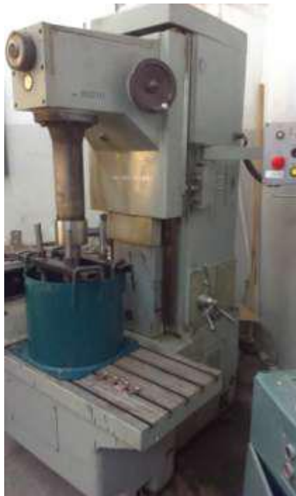
Рис. 2.3. Загальний вигляд лабораторної установки для дослідження зношування деталей робочих органів під час взаємодії з ґрунтом
