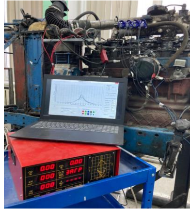
Рис. 2.4. Експериментальний стенд з оснащеною системою запалювання біогазової силової установки 4ГЧ11/12,5, загальний вигляд.
