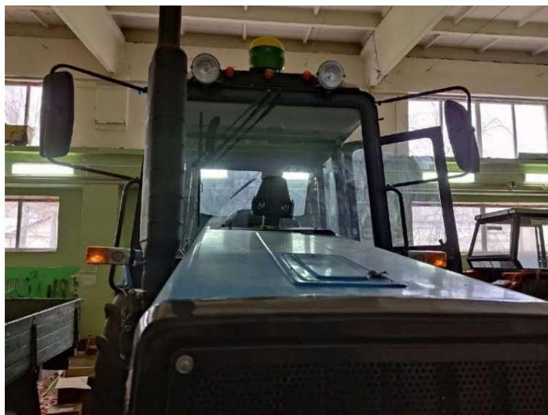
Рис. 2.8. Навігаційна система Starfire-3000 на тракторі Беларус-1221.2
