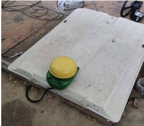
Рис. 2.9. Модуль навігаційної системи Starfire-3000, встановлений на даху трактора Беларус-1221.2.
