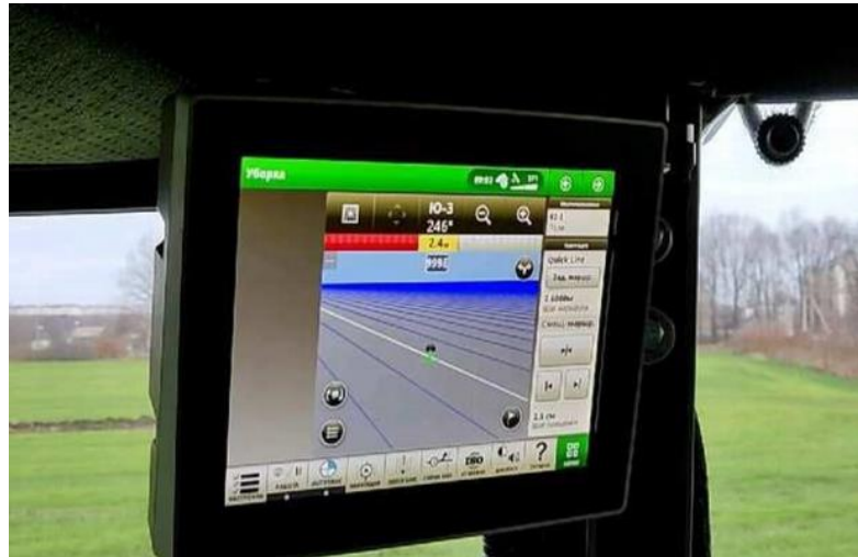
Рис. 2.10. Монітор GreenStar-4240 у кабіні трактора Беларус-1221.2
