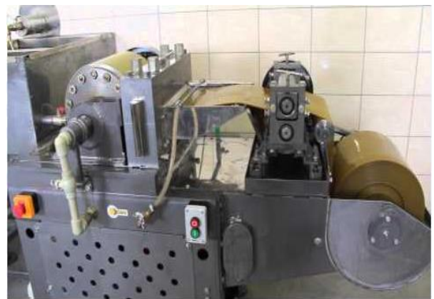
Рис. 3.4–3.5. Агрегат АІВ-100 для виробництва штучної вощини
