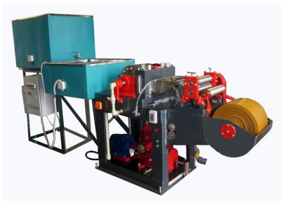
Рис. 3.4–3.5. Агрегат АІВ-100 для виробництва штучної вощини
