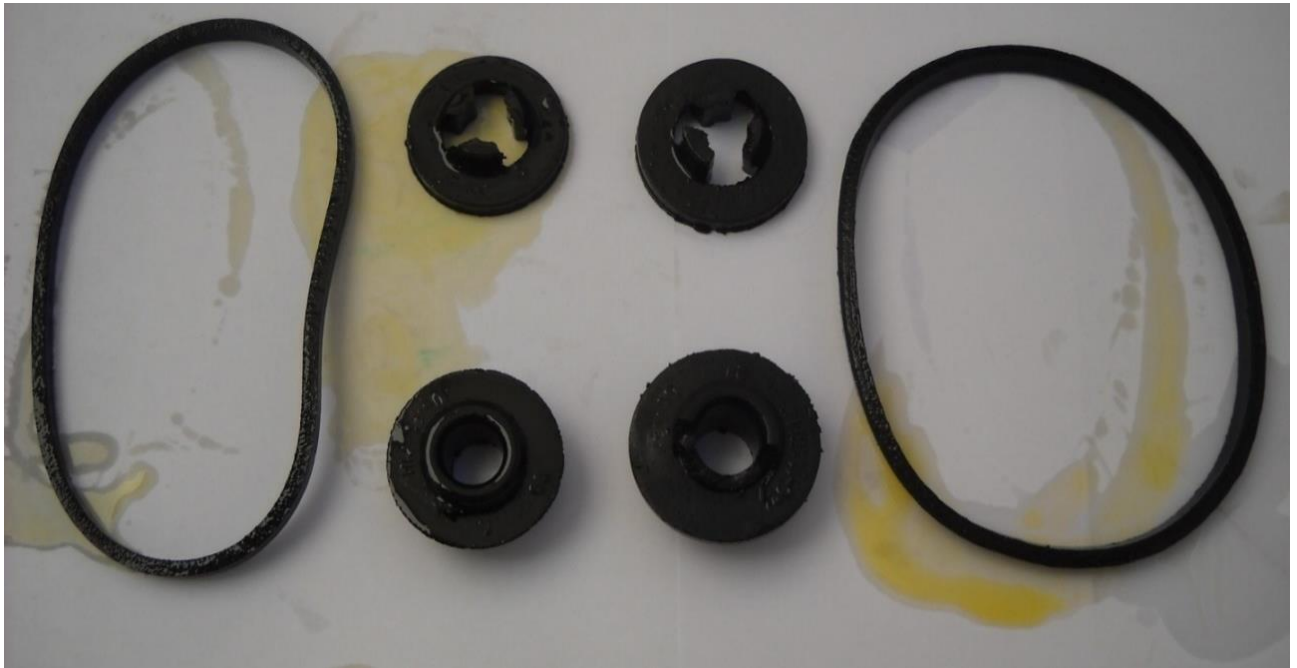
Рис. 3.7. Гумотехнічні вироби (рем. комплект фільтра тонкого очищення пального), витягнуті з ємності з ріпаковою олією (№ 1, 2, 3) і дизельним паливом (№ 4, 5, 6) [6].
