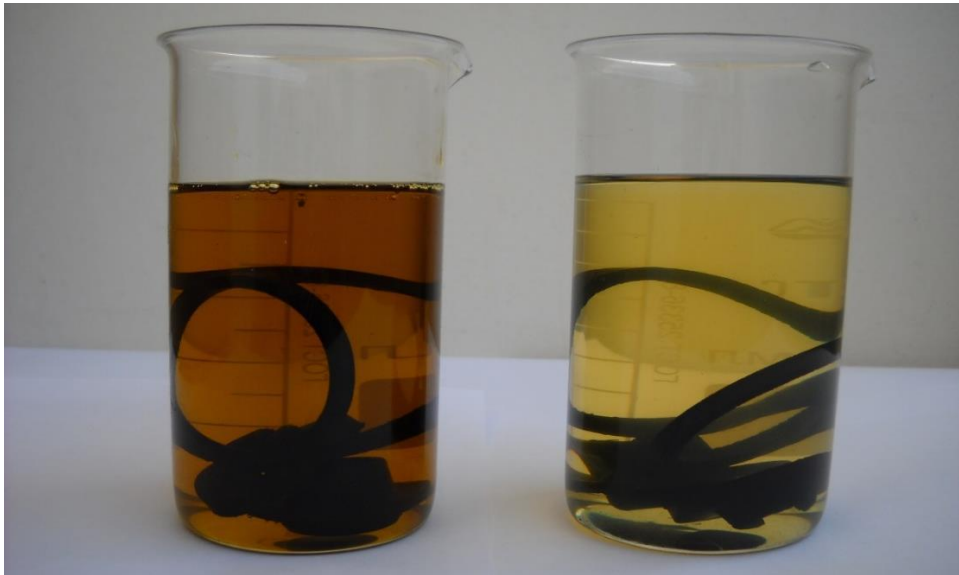
Рис. 2.8. Гумотехнічні вироби фільтрів: 1 – у рапсовій олії; 2 – у дизельному паливі.
