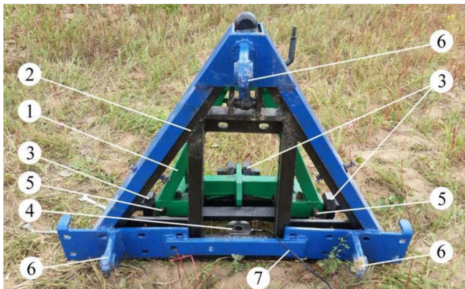
Рис. 2.3. Тензометричне навішування: 1, 2 – трикутні конструкції; 3 – шарніри; 4 – S-подібний датчик; 5 – упорні болти; 6 – кронштейни; 7 – електричний кабель.
