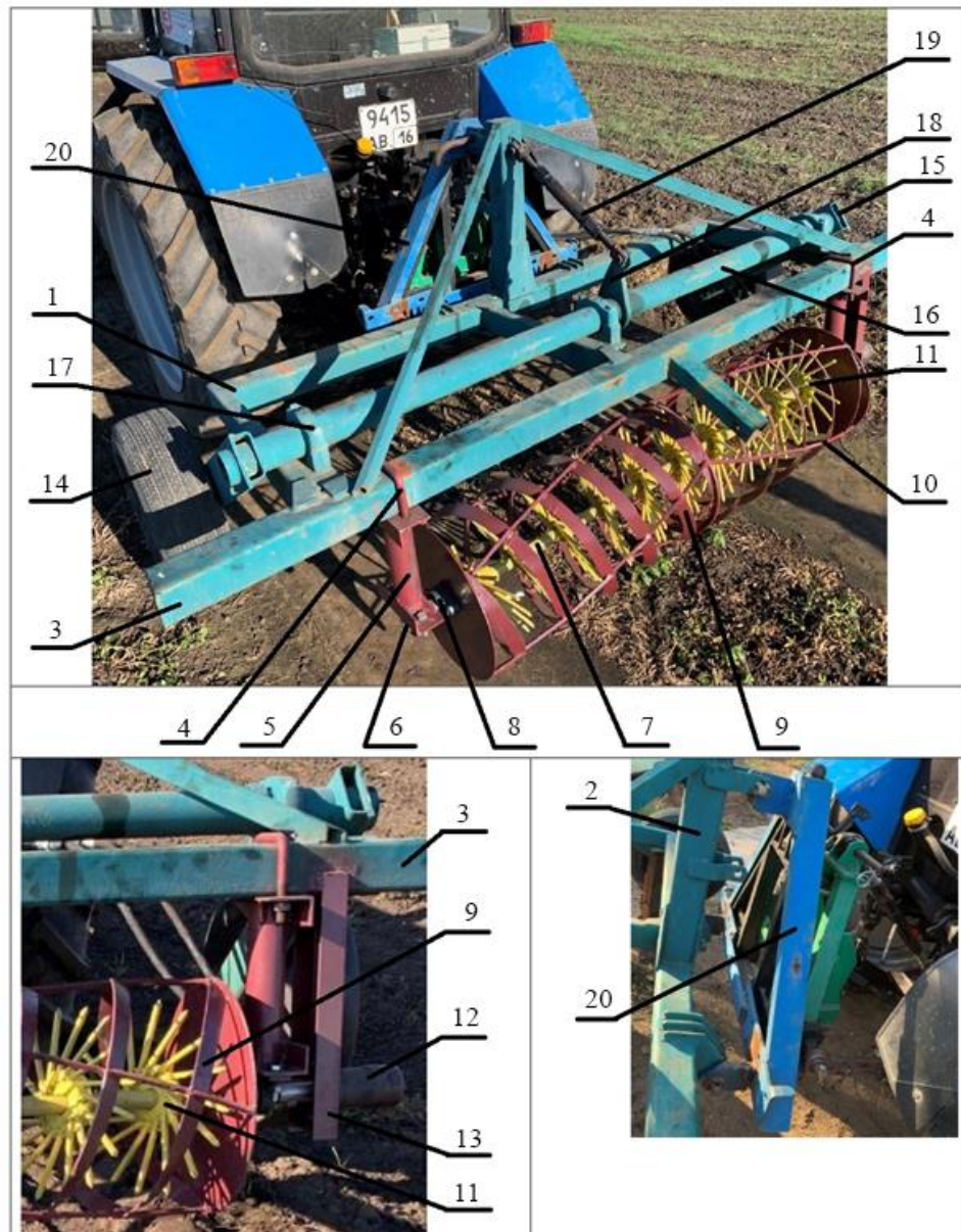
Рис. 2.2. Дослідний зразок знаряддя: 1 – рама; 2 – система навішування; 3 – несуча балка; 4 – хомути; 5 – стійки; 6, 8, 17 – підшипникові опори; 7 – горизонтальний вал; 9 – спіральньо-гвинтовий робочий орган; 10 – гвинтові квадратні прутки; 11 – еліпсоподібні голчасті диски; 12 – гідромотор; 13 – стійка гідромотора; 14 – опорні колеса; 15 – повідці; 16 – труба; 18 – важіль; 19 – регульовальна тяга; 20 – тензометрична навіска.
