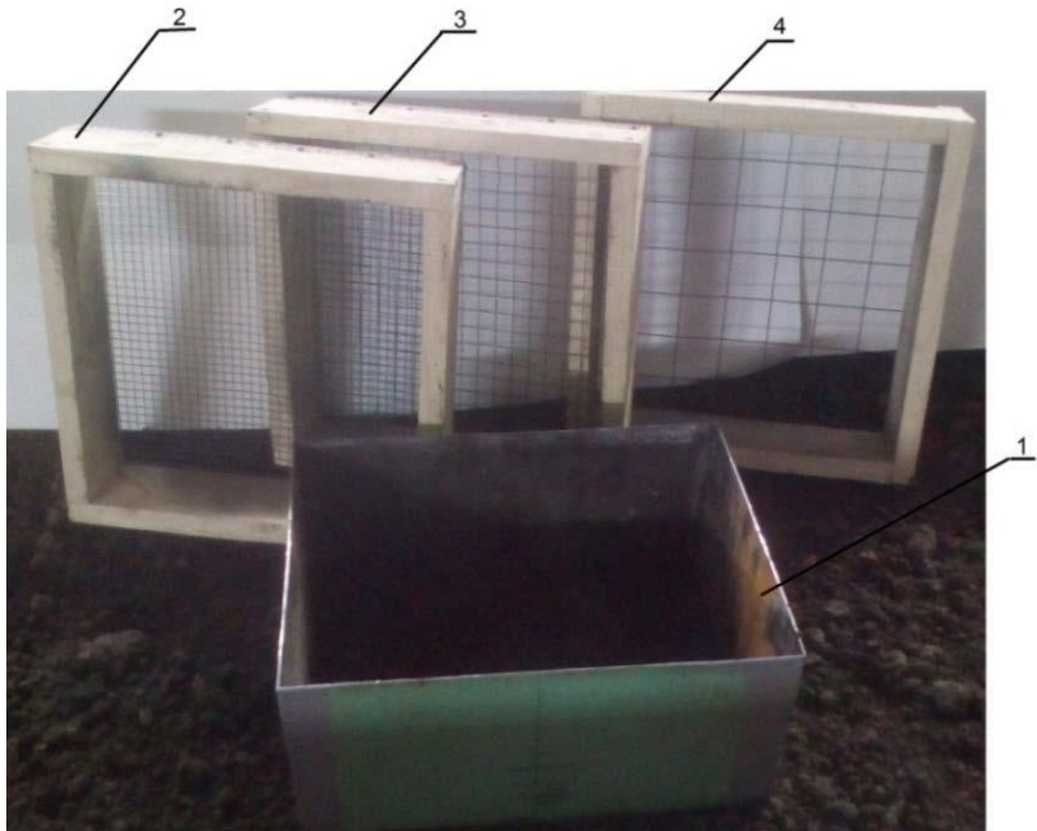
Рис. 2.7. Контейнер із лабораторними ситами: 1 – контейнер; 2, 3, 4 – сита лабораторні
