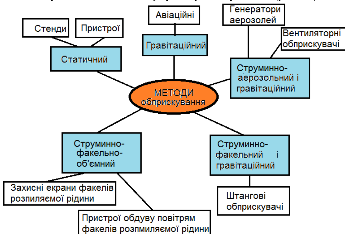
Рисунок 1.2 - Система методів та засобів для технології обприскування рослин
