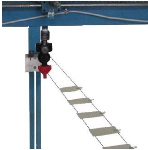
Рисунок 3.4 – Пристрій для просторового розміщення об'єктів обробки (картки із паперу) під факелом розпилювальної рідини
