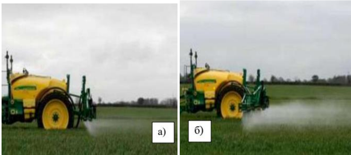
Рисунок 1.6. Висота розміщення штанги при використанні розпилювачів з кутом розпилу 110^{\circ} : а) висота штанги на рослинами 50 см; б) висота штанги над рослинами 80 см.
