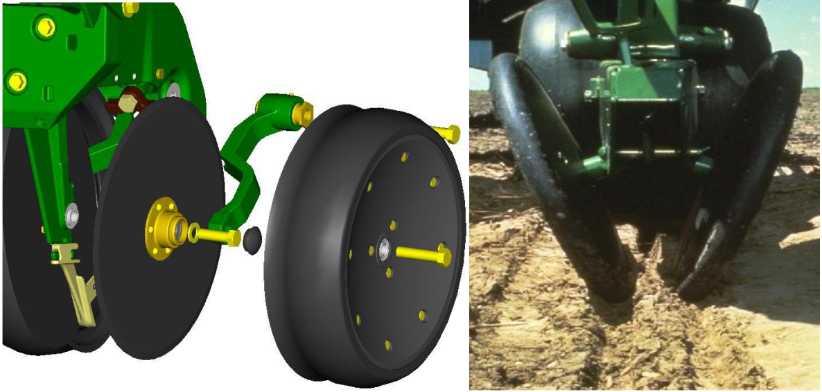
Рис. 3.3. Сошникова група секції сівалки із запропонованим загортачем
