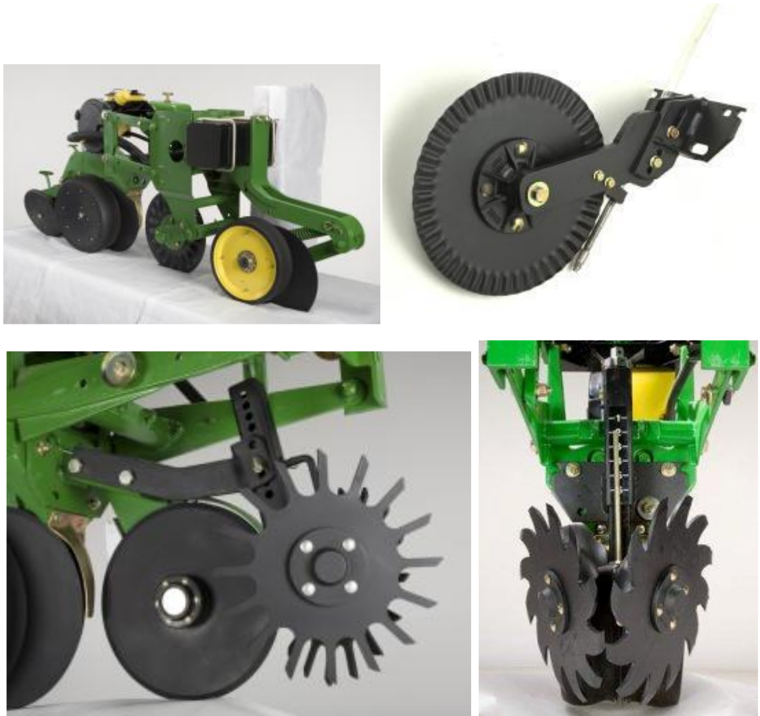
Рис. 3.4. Запропонована сонникова група сівалки з прорізним диском та прогортачем рослинних та поживних решток
