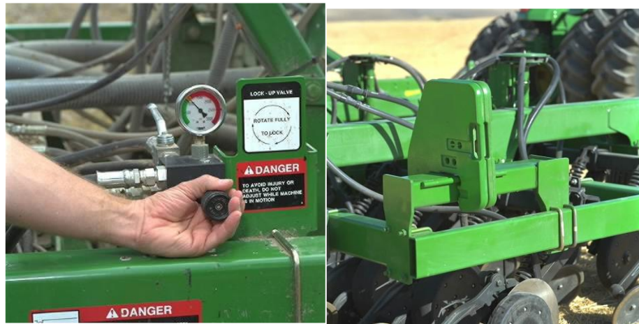
Рис. 1.6. Регулятор гідравлічного блокування та системи механічного довантаження сошників
