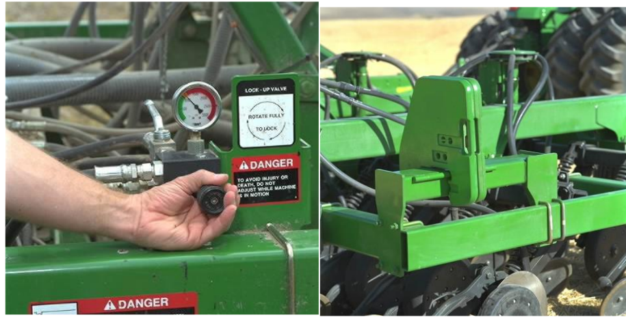
Рис. 3.6. Регулятор гідравлічного блокування та системи механічного довантаження сошників
