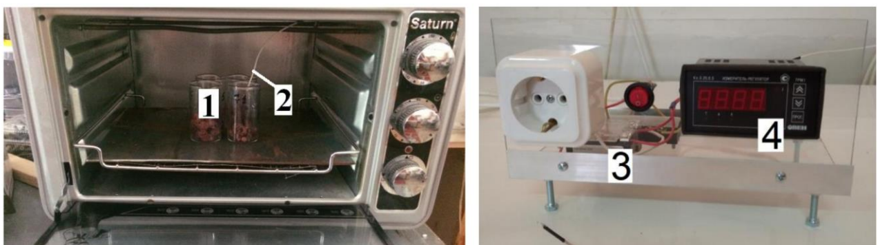
Рис. 2.9. Лабораторна установка для визначення кількості вологи в сировині та продукті сушіння: 1 – ємності зі зразками; 2 – термопара; 3 – твердотільне реле; 4 – регулятор ТРМ1.
