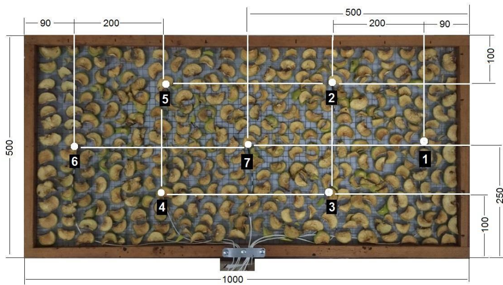
Рис. 2.6. Розташування робочих спаїв термопар на експериментальному лотку: 1 - 7 – термопари.
