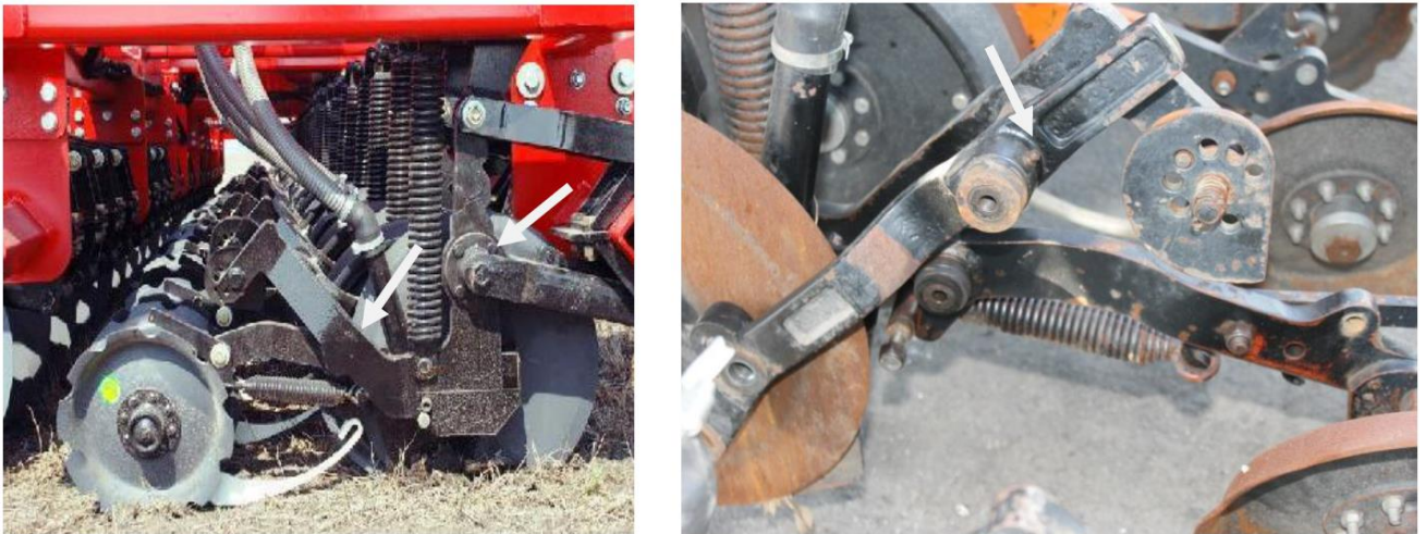
Рис. 1.10. Точки змащування трибоспряження з підшипником ковзання (стрілка вказує на точку обслуговування рухомого з'єднання висівної секції) [8]
