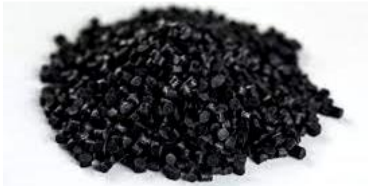
Рис.2.3. Вугленаповнений поліамід, гранули чорного кольору, частка наповнювача 30% УПА-6-30
