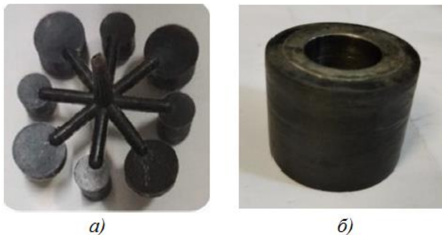
Рис. 2.6. Зразки для експериментальних дослідження: а) міцнісних та триботехнічних характеристик та властивостей; б) величини зносу (з внутрішньою вставкою)
