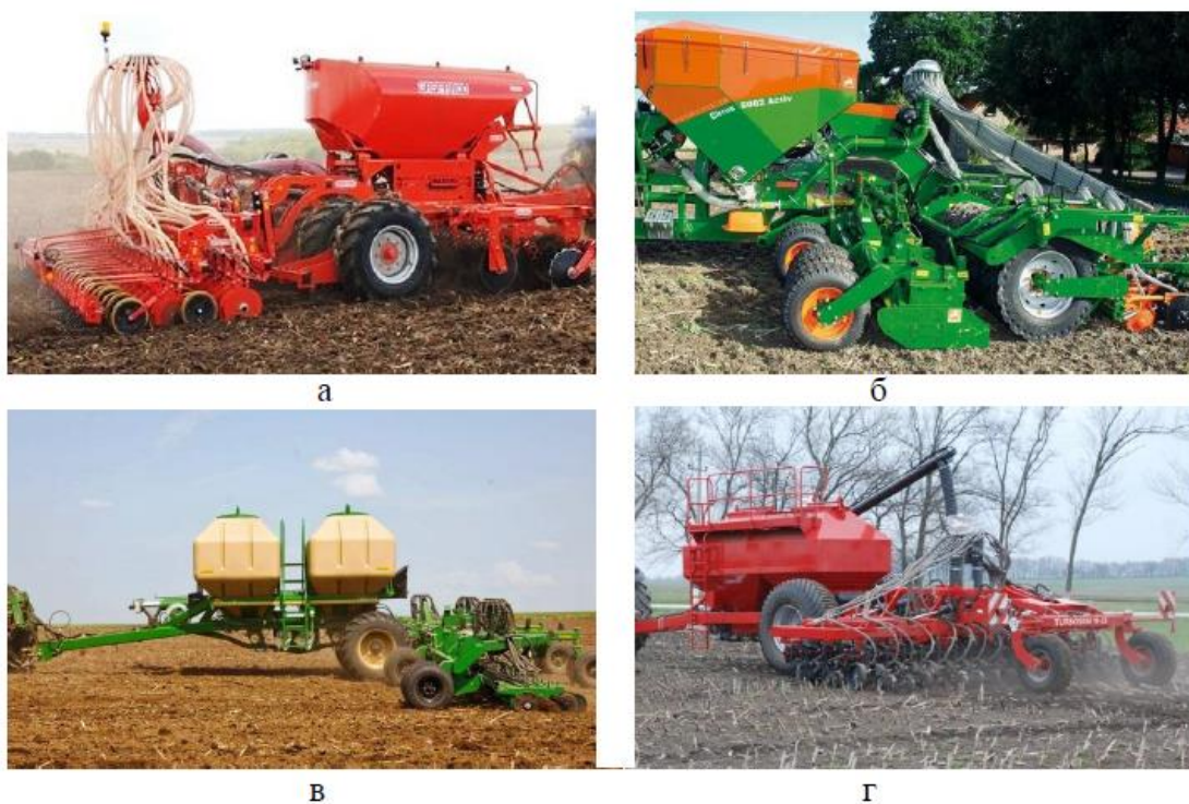
Рис. 1.3. Загальний вигляд роздільно-агрегатних посівних машин: а) Gaspardo PE 300; б) Amazone Cirrus; в) Great Plains STA-400; г) Агро-Союз Turbosem II 19-32
