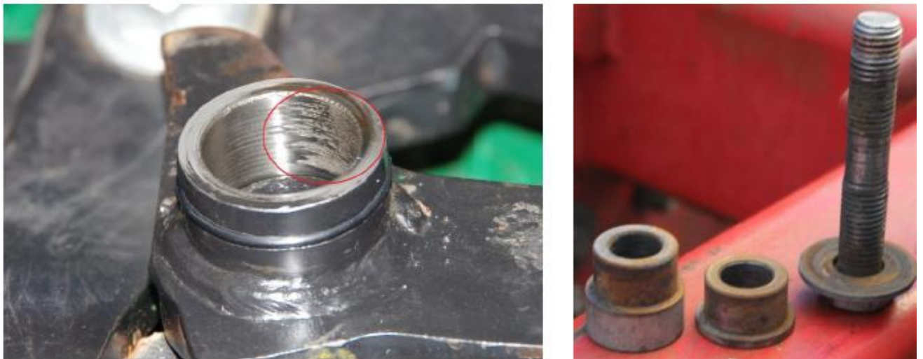
Рис. 1.5. Надмірний знос металевих елементів рухомих з'єднань механізму копіювання рельєфу посівного комплексу Агро-Союз Turbosem II 19-60 після 1500 га експлуатації
