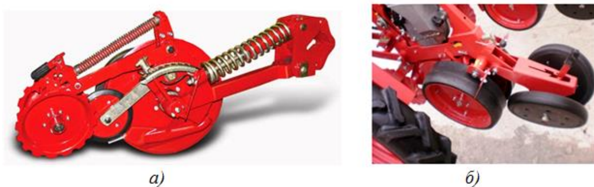
Рис.1.6. Посівна секція посівного комплексу ORION 9,6 з механізмом копіювання поверхні поля – а, посівна секція сівалки VEGA PROFІ (АТ «Ельворті») – б [10]
