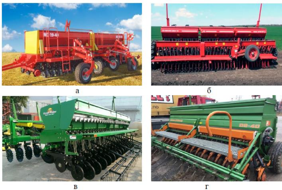
Рис. 1.2. Загальний вигляд моноблочних сівалок: а) Агро-Союз MD 19-20; б) ASTRA 5,4; в) Great Plains 2000; г) Amazone D9–4000 Super
