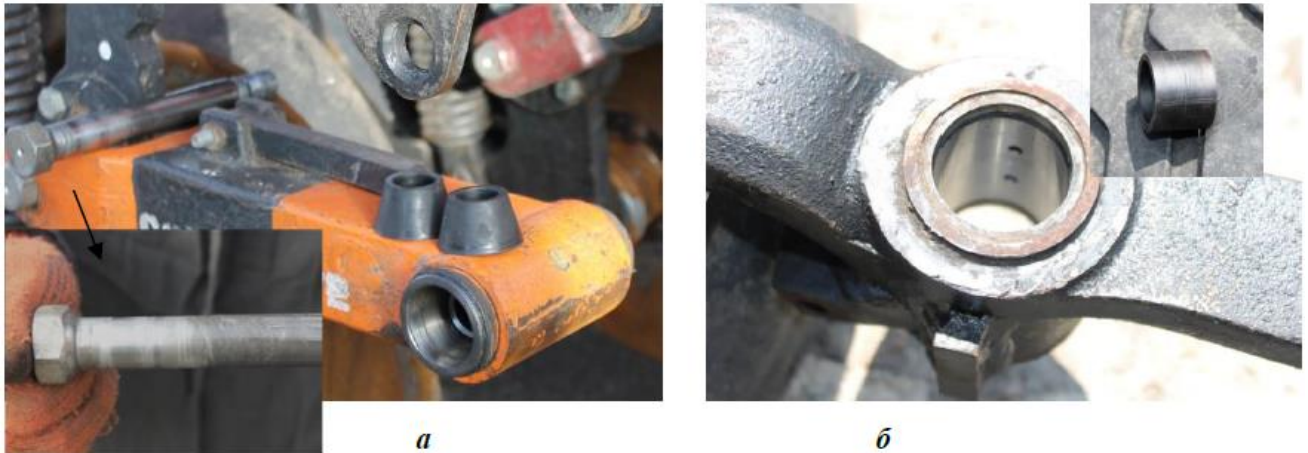
Рис. 3.5. З'єднання, що рухаються в посівному комплексі John Deere 1780 (після напрацювання 9180 га): а – деталі нижнього паралелограма; б – деталі шарніра опорного колеса
