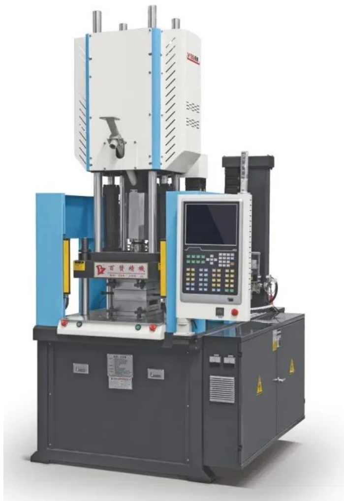
Рис.2.3. Вертикальна ливарна машина під тиском Номтар
