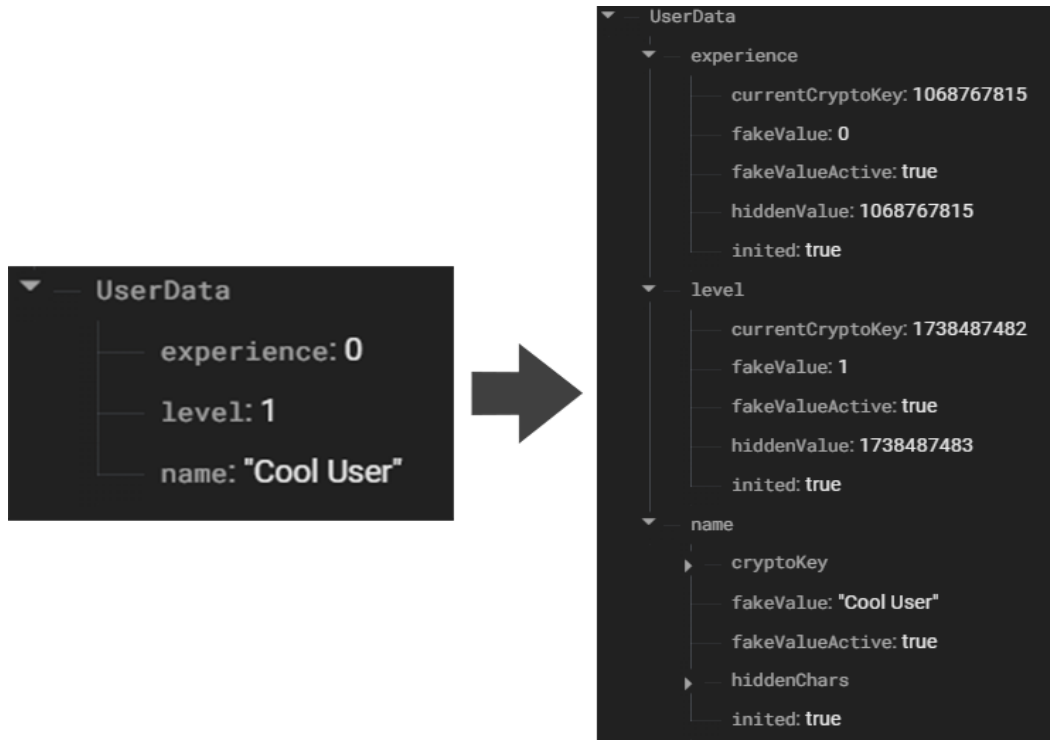
Рисунок 2.20 – Дані « UserData » до та після шифрування
