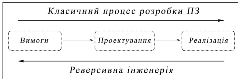
Рисунок 1.1 – Порівняння класичного процесу розробки ПЗ та реверсивної інженерії
