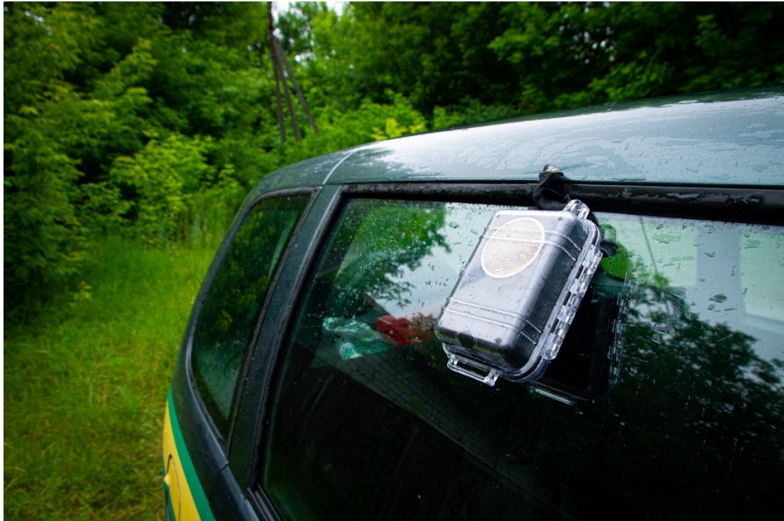
Рис. 2.1. Зовнішній вигляд та розташування трекера-дозиметра bGeiger Nano на службовому транспорті
