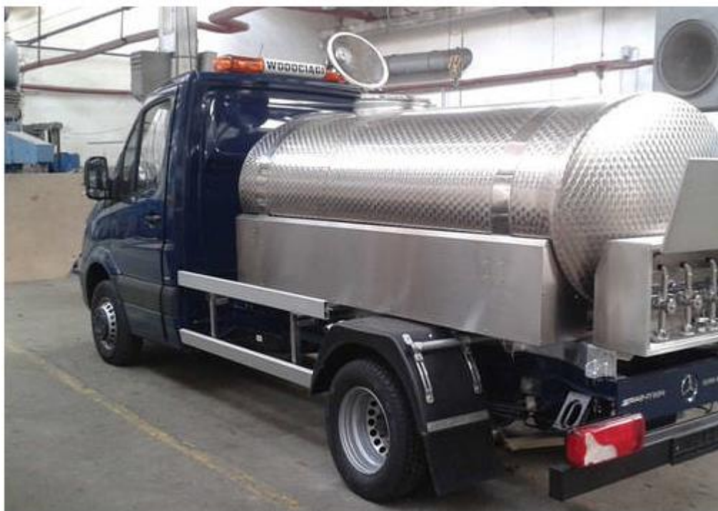
Рис. 3. Цистерна для транспортування молока
