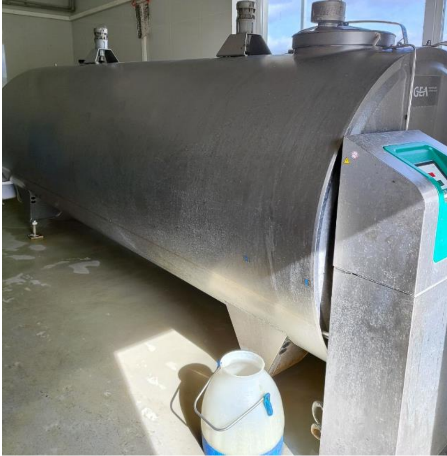
Рис. 2. Танк для охолодження молока.
