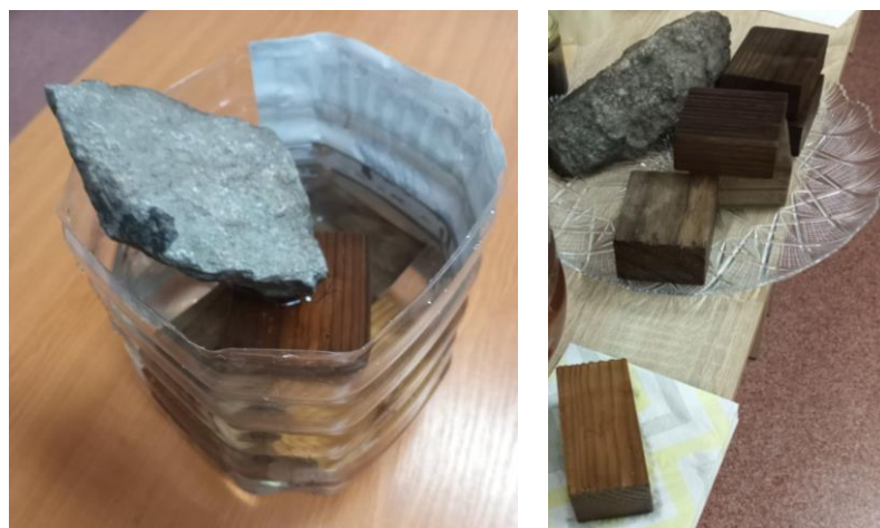
Рис. 13. Вимірювання гідратації (водопоглинання) шляхом повного занурення одночасно у воду всіх зразків.
