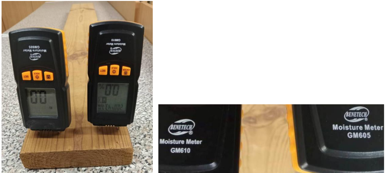
Рис. 12 . Результати вимірювання вихідної вологості термомодифікованої сосни моделі вологомірів.
