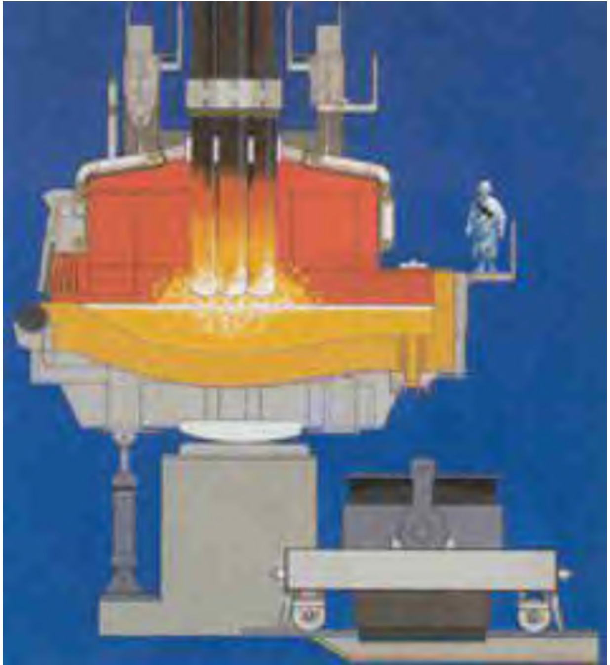
Рис.3.3. Функціональна схема печі ДСП-3.
