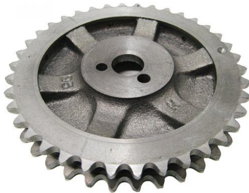
Рисунок 1.2. Зірочка приводу розподільного валу двигуна ВАЗ-2101
