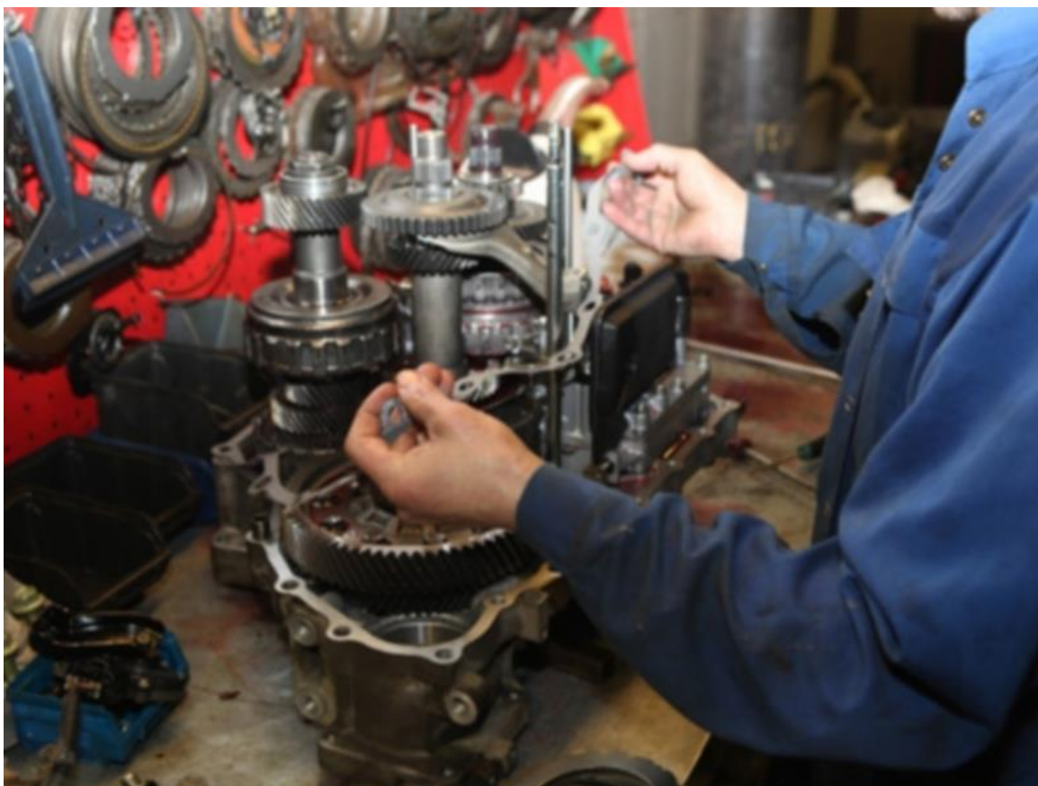
Рис. 1.2. Розбирання та дефектування коробки передач
