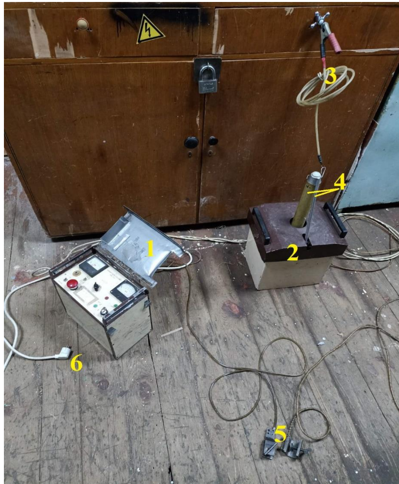
Рисунок 3.3 – Випробувальна установка АІД-70 в зборі та готова до проведення випробувальних робіт.
