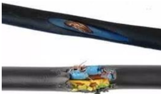
Рисунок 1.4 – Приклад механічного дефекту ізоляції струмовідних частин.
