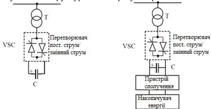
Рисунок 2.3. Структурна схема регулятора SVC
