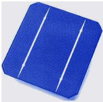
Рис.1.3. Фотографія лицеві поверхні кремнієвого сонячного елемента
