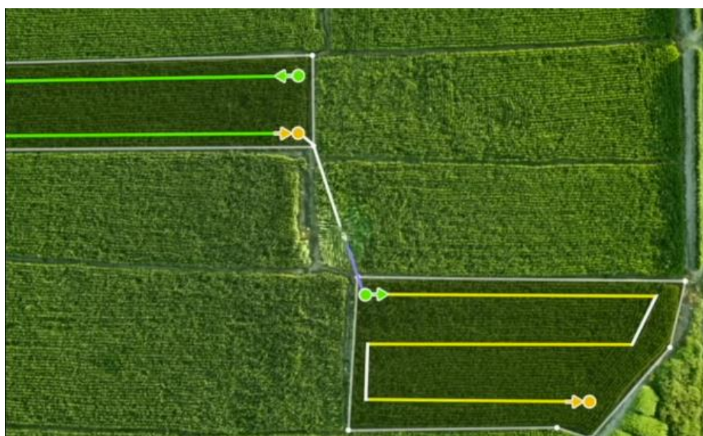
Рис. 7.7. Оптимізований маршрут для переміщення в межах мультиполігону.
