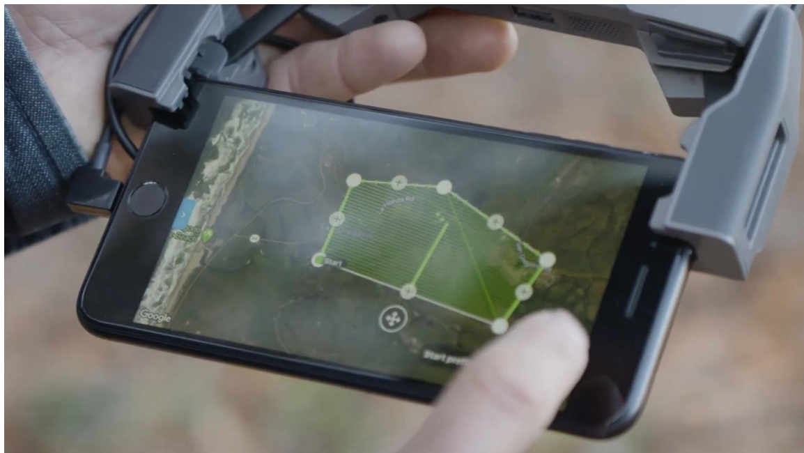
Рис. 7.2. Створення контуру поля в ПО « DroneDeploy ».
