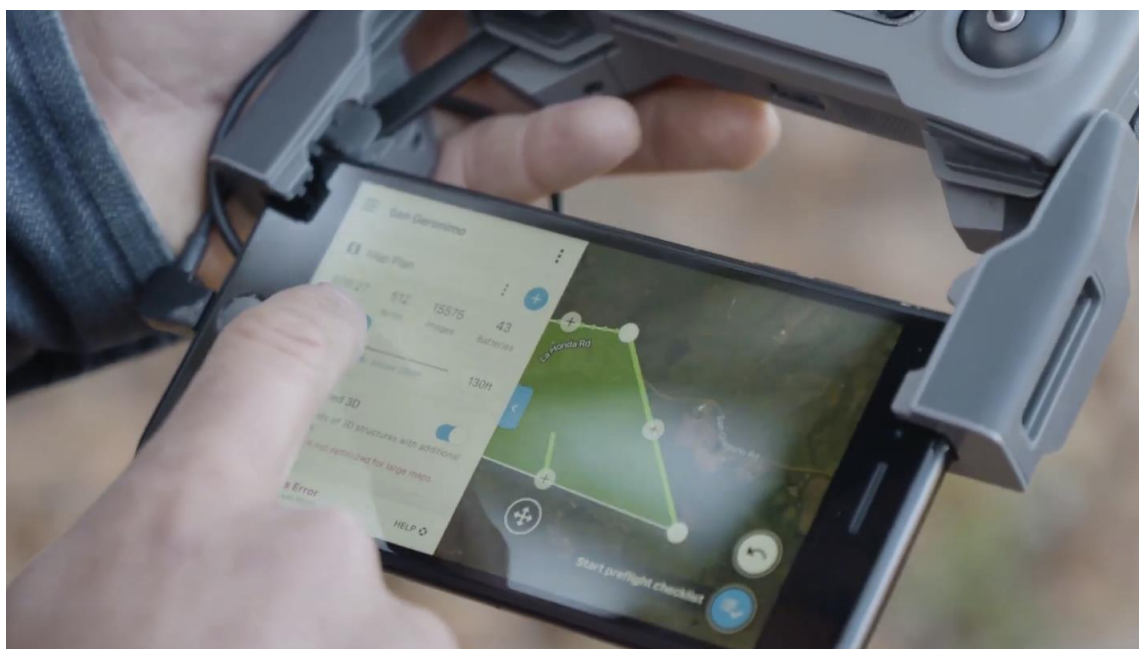
Рис. 7.3. Розрахунок ефективного маршруту польоту в ПО « DroneDeploy ».
